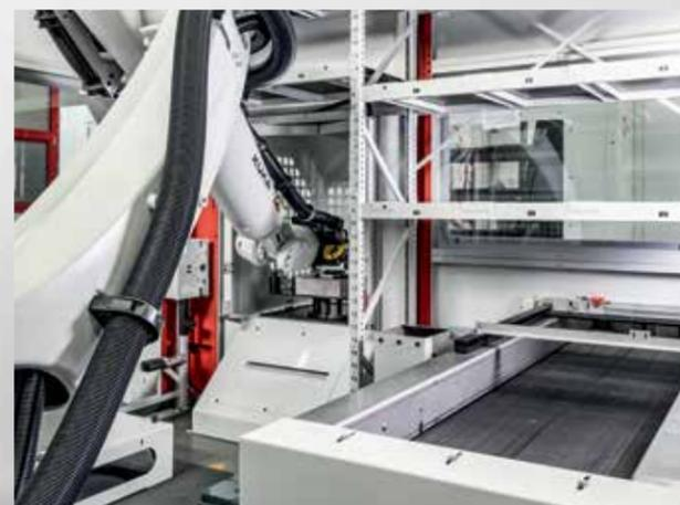
Zásobník palet, osazovací stanoviště (vzadu) a pásový dopravník pro obrobky
