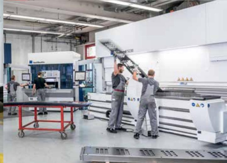
S novým laserovým děrovacím strojem a dvěma novými ohraňovacími lisy pro segmenty velkých i malých dílů je Hermle ve výrobě plechů na aktuální úrovni
