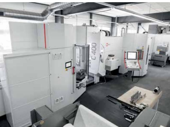
Na obrázku je vidět část "bulváru Hermle" ve firmě Feusi AG s 5osým obráběcím centrem C 400 U s obrobkovým zásobníkem, 5osým obráběcím centrem C 22 U s výměníkem palet PW 150, a 5osým obráběcím centrem C 42 U/MT s funkcí obrábění
