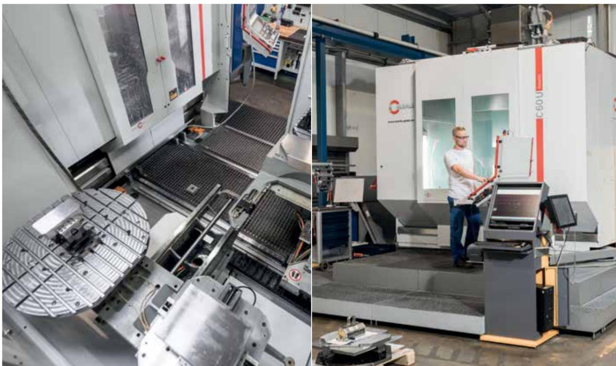
vlevo Systém výměny palet vysoce flexibilně použitelného 5oseho vysokovýkonného CNC obráběcího centra C 42 UP pro nepřetržitou kompletní výrobu formovacích desek, formovacích nástavců a aktivních dělů z oboru konstrukce nástrojů a strojů vpravo 5ose vysokovýkonné CNC obráběcí centrum C 60 U pro velké díly.
