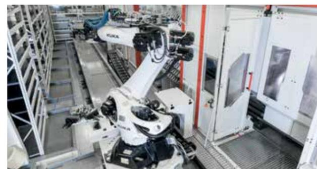
perspektivní náhled na flexibilní výrobní buňku oblastí zásobníku s paletami obrobků (vlevo a vzadu), vpravo v oblasti dílů zásobník pro 200 nástrojů, vpravo vpředu také napojení obráběcího centra C 42 U a uprostřed robot, který je jako multifunkční systém odpovědný jak za manipulaci s paletami obrobků, tak i za výměnu nástrojů
