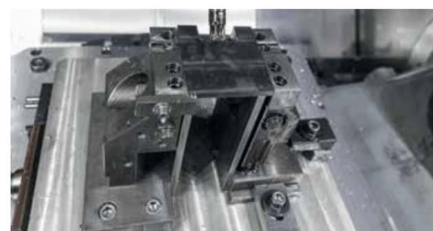
pracovní prostor 5osého vysokovýkonného CNC obráběcího centra C 42 U s NC naklápěcím otočným stolem o průměru 800 x 630 mm a na paletě upnutý upínací přípravek pro 5osé obrábění obrobku
