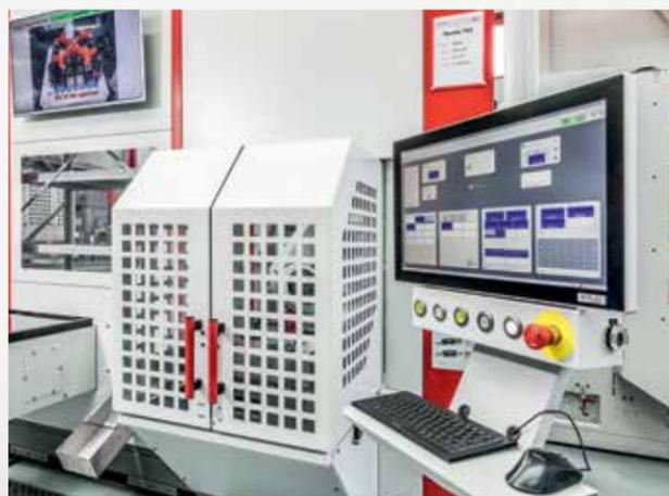
Robotický systém RS 2 Kombi s kanban, připojený k 5osému obráběcímu centru C 32 U dynamic
